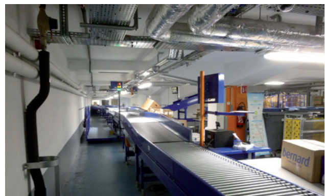
Exemple de l'aire de manutention de l'ELU de Beaugrenelle : un convoyeur à rouleaux commandés permet d'acheminer les colis depuis le PL (flux entrant de marchandises massifié), vers les VUL (à faibles émissions) qui partiront en tournée de livraison une fois la répartition des colis achevée. Les caisses mobiles préparées en amont permettent d'optimiser ce temps de manipulation.
