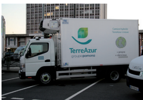
Camion 7,5T hybride diesel et électrique à température dirigée
