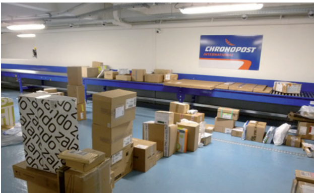
Exemple de l'aire de manutention de l'ELU de Beaugrenelle : un convoyeur à rouleaux commandés permet d'acheminer les colis depuis le PL (flux entrant de marchandises massifié), vers les VUL (à faibles émissions) qui partiront en tournée de livraison une fois la répartition des colis achevée. Les caisses mobiles préparées en amont permettent d'optimiser ce temps de manipulation.
