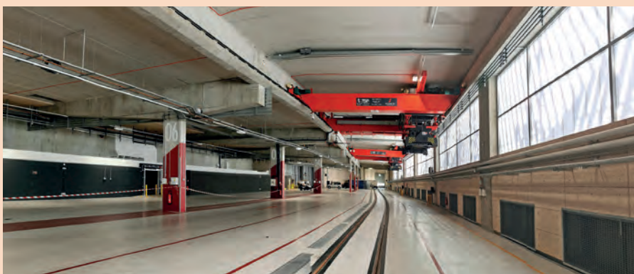
Le pont roulant installé pour permettre le transbordement des conteneurs entre le train et les camions
