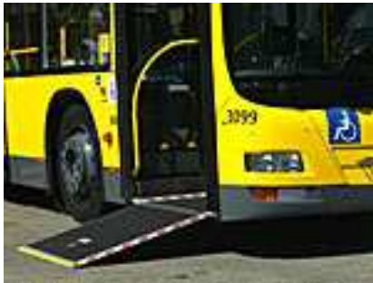
L'accès des personnes à mobilité réduite se fait par la porte avant Document BVG
