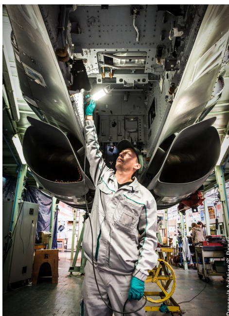
Unité d'assemblage de la structure Rafale. Retrofit Rafale M9 du standard F1 vers F3, dans l'établissement Dassault Aviation à Argenteuil.
