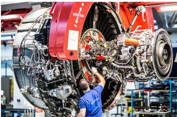
Assemblage final d'un moteur Leap sur le site de Safran Aircraft Engines à Villaroche
