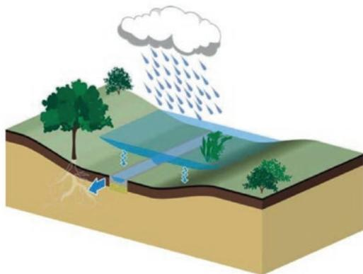
Schématisme d'une noue infiltrante.
