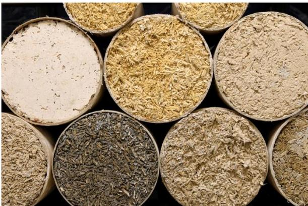
Figure 41 : Eprouvettes bétons végétaux - © HA Segalen
