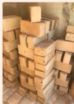
LE TIERS-LAB DES TRANSITIONS Briques en terre crue
