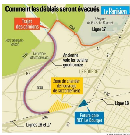
Figure 24. Schéma d'évacuation des déchets du chantier de la gare Bourget-RER (Le Parisien du 5 mars 2019).
