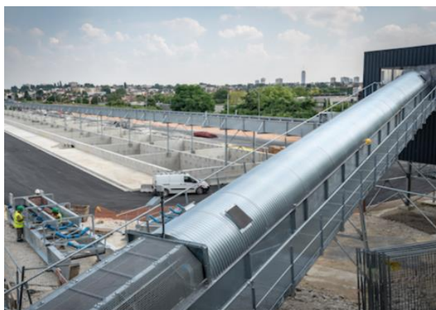
Image 22. Bande convoyeuse reliant l'ITE de Bry-Villiers-Champigny au-dessus du RER E (source : Société des Grands Projets, novembre 2021).
