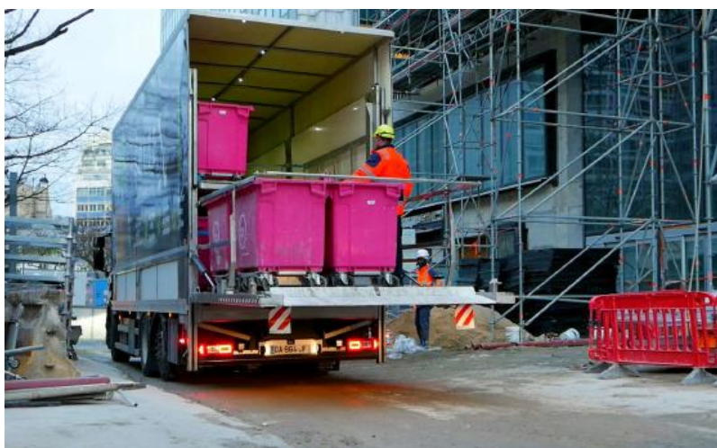
Illustration 12A. Collecte de déchets en reverse logistique à l'aide d'un camion double plancher (Source La Boîte X).
