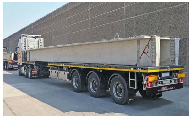
Illustration 12. Transport d'engins spéciaux sur plateau (a) et de pièces préfabriquées en béton (b) sources : S.D.A et Maxtrailer
