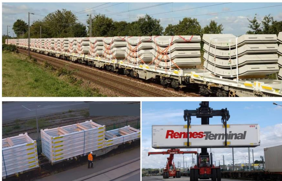
Illustrations 17. Le chantier Eole alimenté par transport combiné rail-route transport de béton précontraint (Photos Lahaye Global Logistics , SNCF Réseau, Ouest-France)
