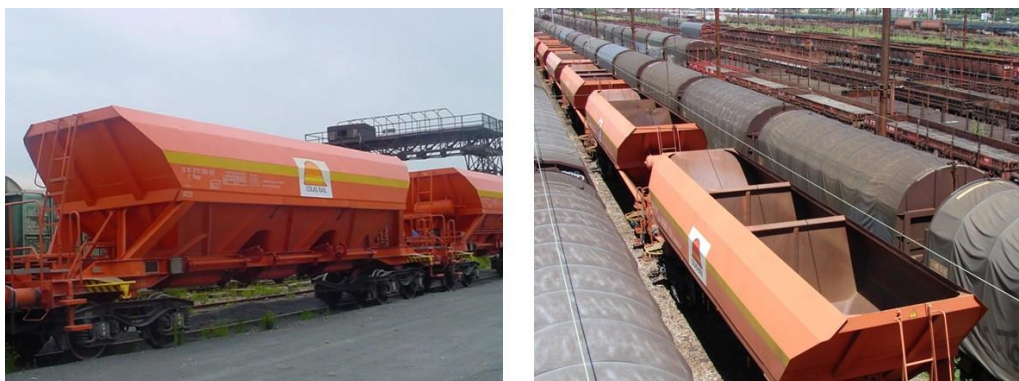
Illustration14. Wagons à trémie Colas double boggies à deux essieux (Source Doc Rail, 2020) 60
