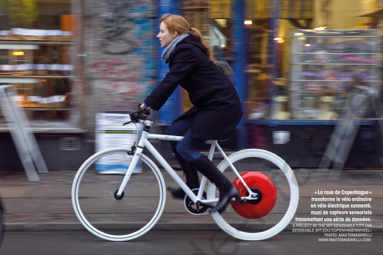
« La roue de Copenhague » transforme le vélo ordinaire en vélo électrique connecté, muni de capteurs sensoriels transmettant une série de données.
