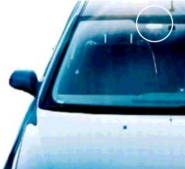
Figure 1.10 - Péage de Stockholm. Badge électronique fixé à l'intérieur du pare-brise (repéré par le cercle blanc)
