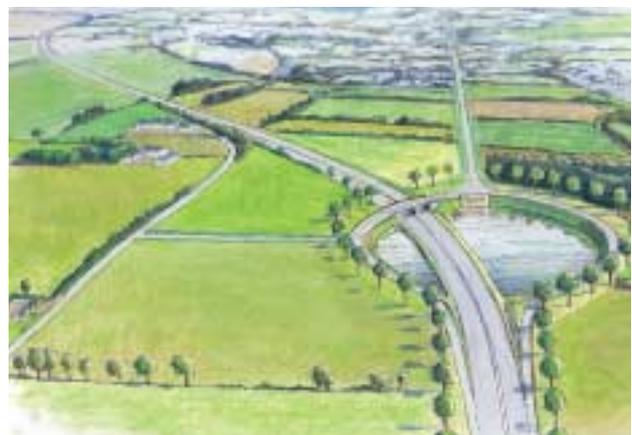
Déviations de Villers-Bocage par A 84. À gauche, option d'une voie autoroutière doublant une route nationale, échangeur peut lisible créant d'importants délaissés. À droite proposition d'une alternative de doublement de l'ancienne route, avec entrée de déviation clairement marquée et transformable en giratoire dénivelé.
