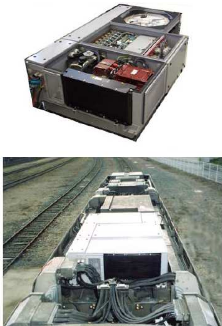
Figure 11.9 Volant d'inertie du tramway Citadis ALSTOM de Rotterdam (Source : ALSTOM)
