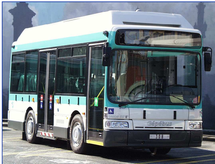
Figure 11.3. Le bus électrique OREOS 55 (Source : RATP)
